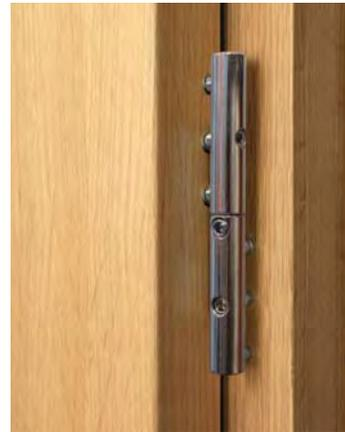
Tous nos modèles de portes sont équipés en standard de paumelles tridimensionnelles permettant un ajustement précis de l'ouvrant sans le dégonder (réglage de la compression de l'ouvrant sur le dormant, réglage latéral et en hauteur du vantail). Les caches-paumelles sont disponibles en ton inox (standard) ou en ton laiton (option).
