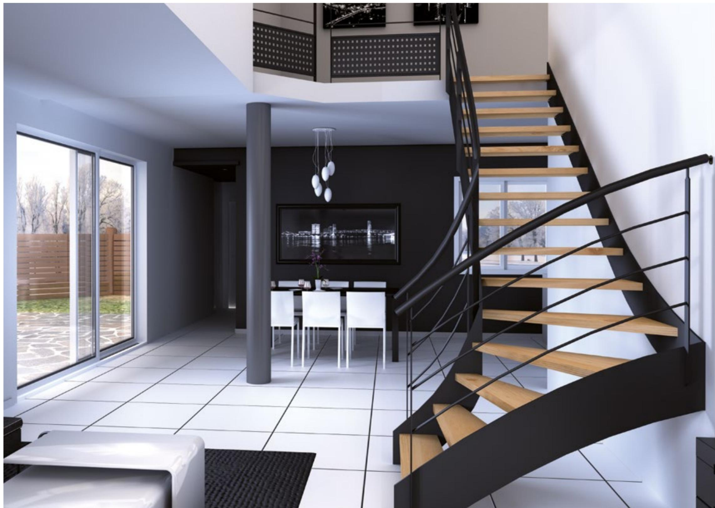
**S.a. CHÈNE.** Escalier ¼ tournant milieu sur limon tôle plat acier, finition thermolaquée effet structuré, main courante ronde, poteaux plats et lisses métal, marches en chêne, garde-corps étage avec soubassement en tôle perforée carrée entre lisses métal.
