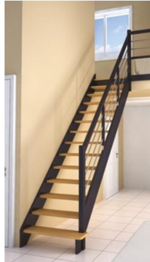
**A.l. HÊTRE.** Escalier droit sur mesure, sans contremarche, lisses inox Ø18, garde-corps étage avec lisses inox et soubassement en vitrage sur lisses bois en hêtre, marche de départ saillante simple. Finition : RAL 9005 et incolore.
