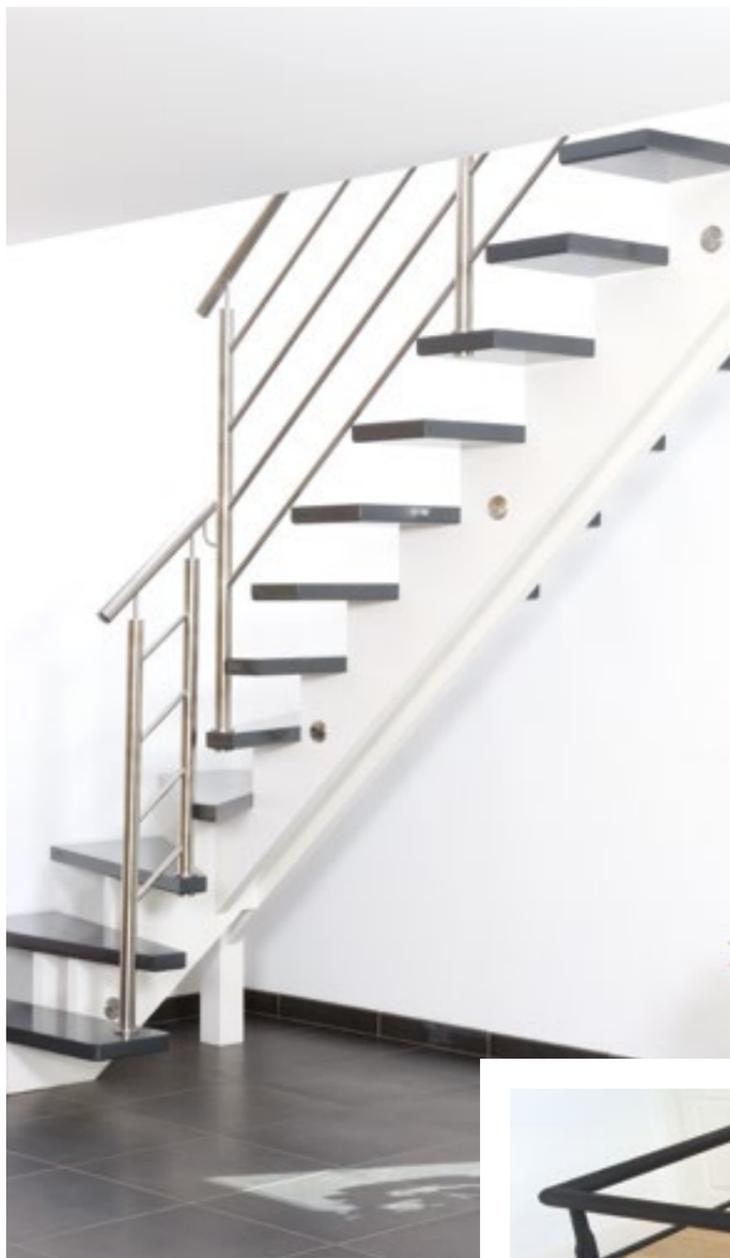
▲ **F.b. HÊTRE.** Escalier ¼ tournant intermédiaire sur crémaillères centrales avec entretoises inox, main courante ronde sur pitons, poteaux ronds et lisses inox, marches bois, fixations inox sur le dessus.
