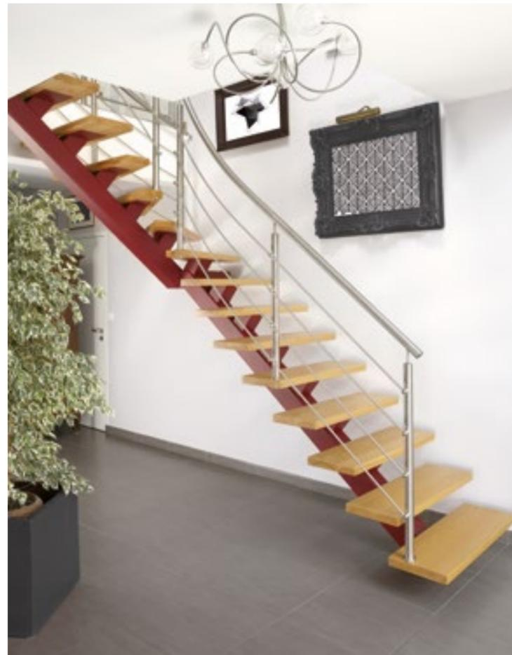
▶ **L.c. HÊTRE.** Escalier ¼ tournant milieu avec poutre centrale acier, marches bois sur consoles acier, finition thermolaquée effet structuré, main courante ronde sur pitons, poteaux ronds et lisses inox.
