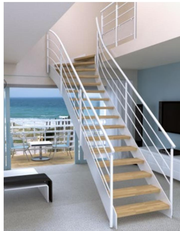
**S.b. HÊTRE LCA.** Escalier ¼ tournant par le haut sur limon tôle plat acier, finition thermolaquée effet structuré, main courante ronde, marches en hêtre LCA, poteaux ronds et lisses acier, garde-corps étage avec soubassement vitrage entre pinces.
