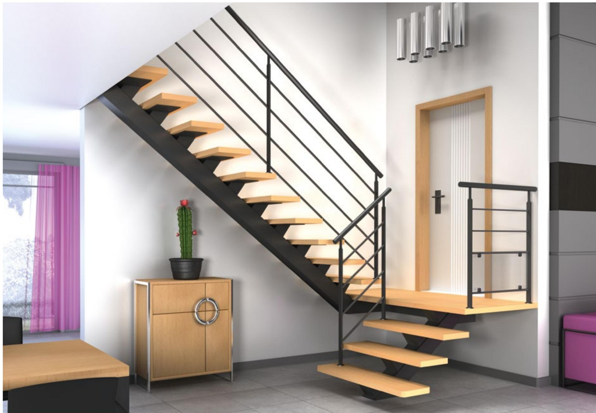
**L.a. HÊTRE.** Escalier deux volées droites avec palier de repos, poutre centrale acier, RAL 7016, marches bois sur consoles acier, finition thermolaquée effet structuré, main courante ronde et poteaux plats.
