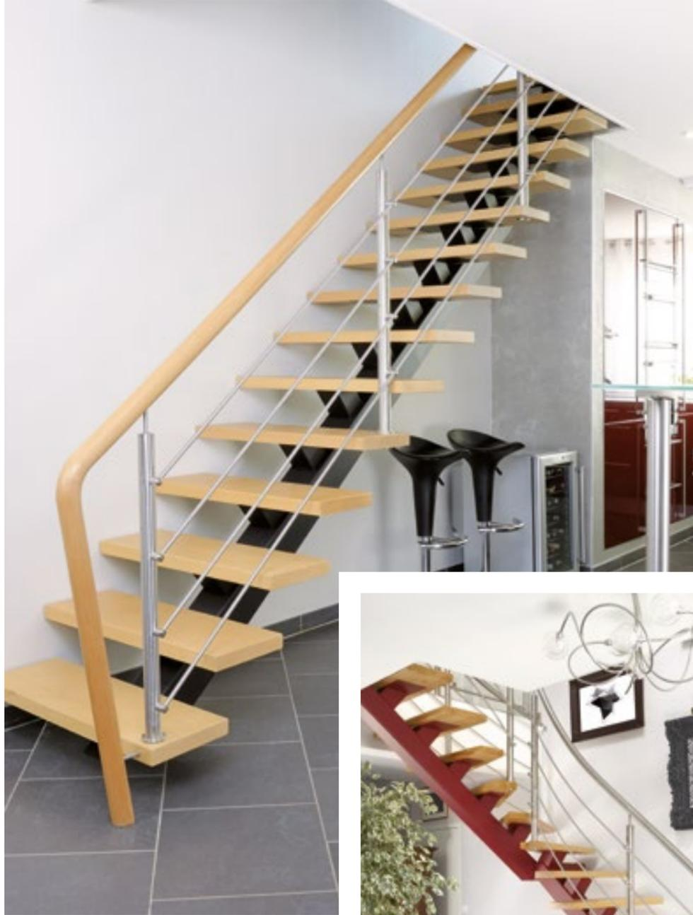
◀ **L.d. HÊTRE.** Escalier droit avec poutres centrales acier, marches bois sur consoles acier, finition thermolaquée effet structuré, main courante ronde en bois sur pitons, poteaux ronds et lisses inox.
